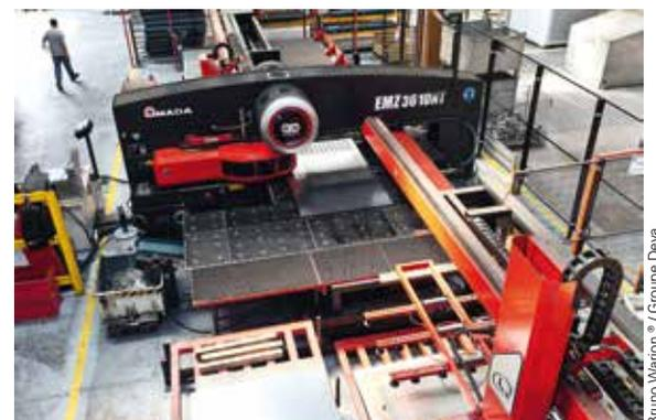
Poinçonneuse à commande numérique
