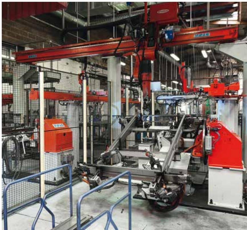
Ilot robotisé de soudure numéro 1
