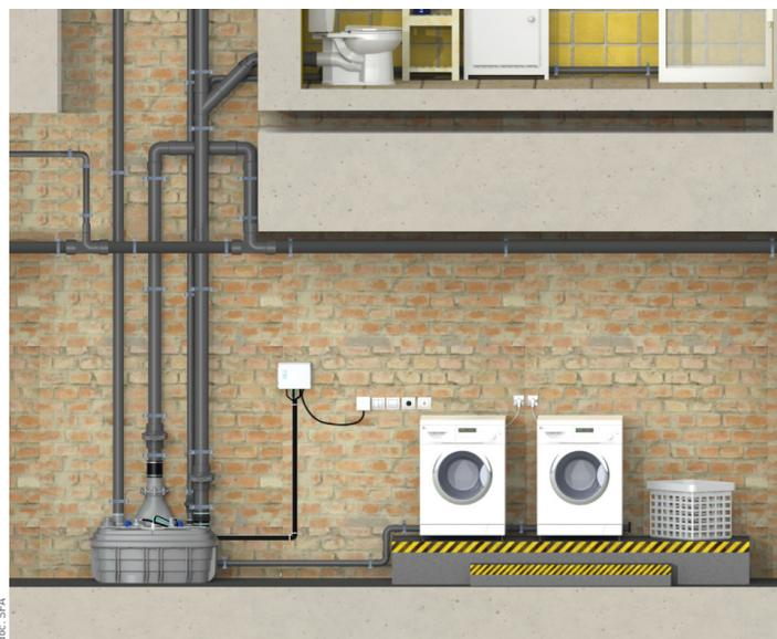
SANICUBIC® 2 XL admet par intermittence (max 5 minutes), des températures d'eau jusqu'à 70 °C, garantie d'une utilisation fiable et pérenne.
