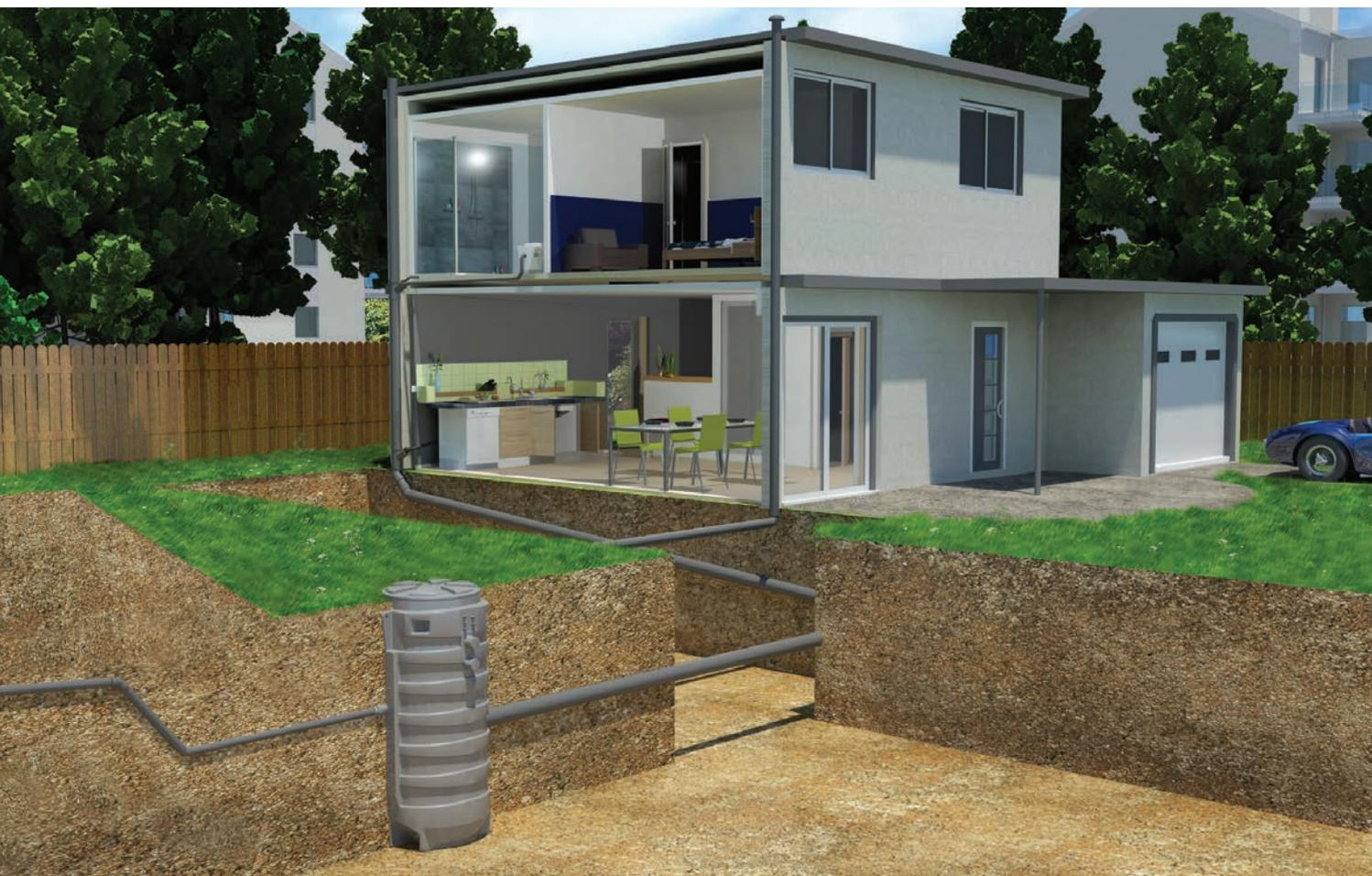
Installation d'une station de relevage SANIFOS® 1300.
