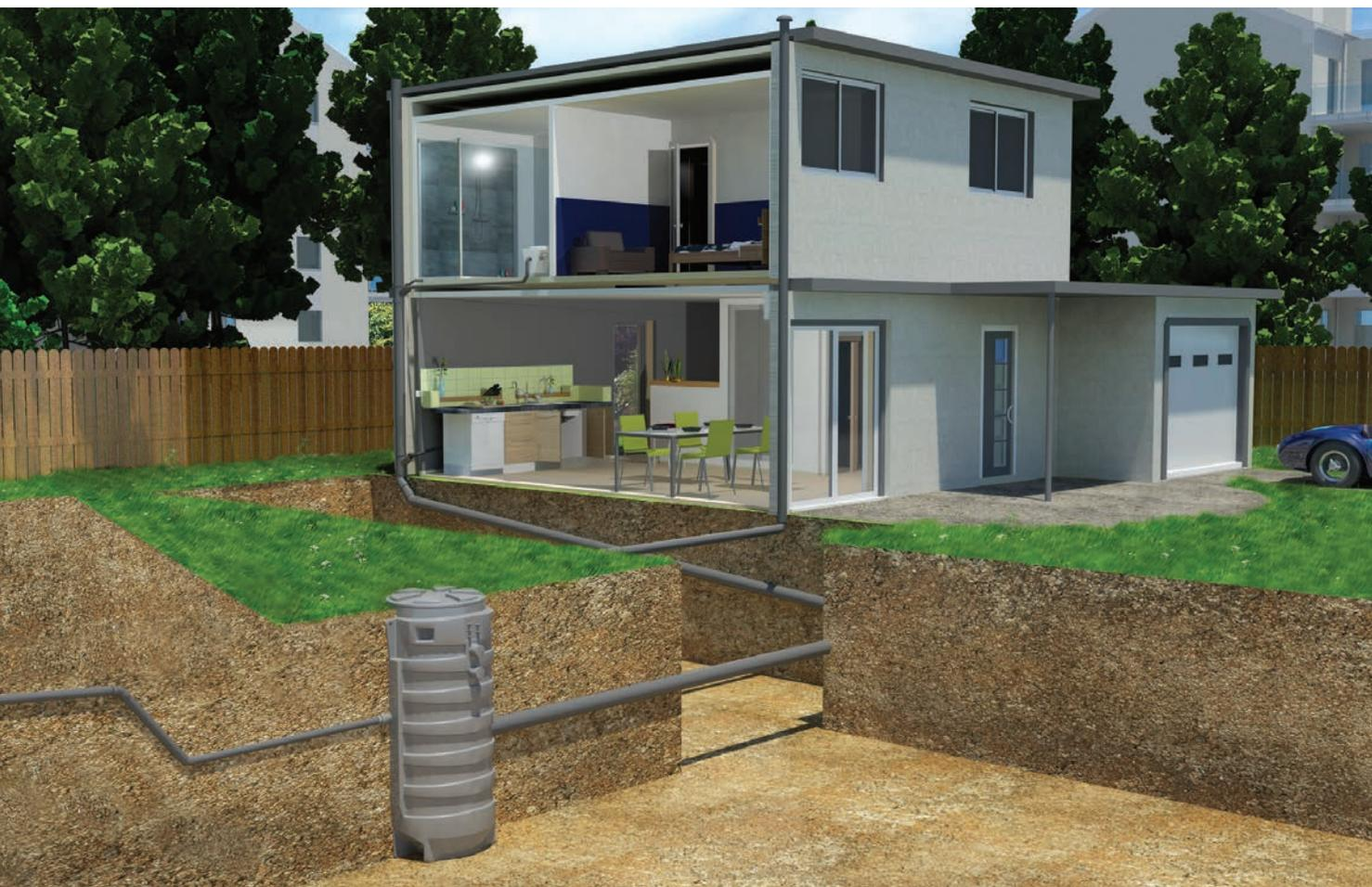
Installation d'une station de relevage SANIFOS® 1300.
