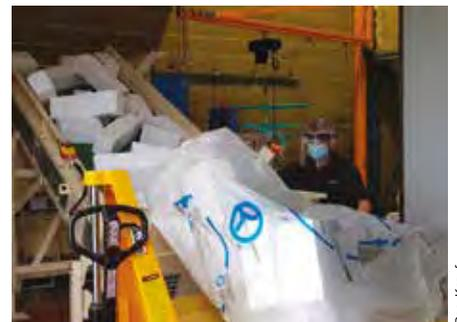
Le PSE collecté est soit broyé et réintroduit dans la fabrication de nouveaux produits en PSE, soit broyé et compacté pour être revalorisé en produits en polystyrène du bâtiment ou de la vie courante.
