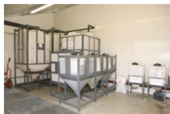
Le local adjuvant et les 7 cases à granulats de la centrale de Langon
