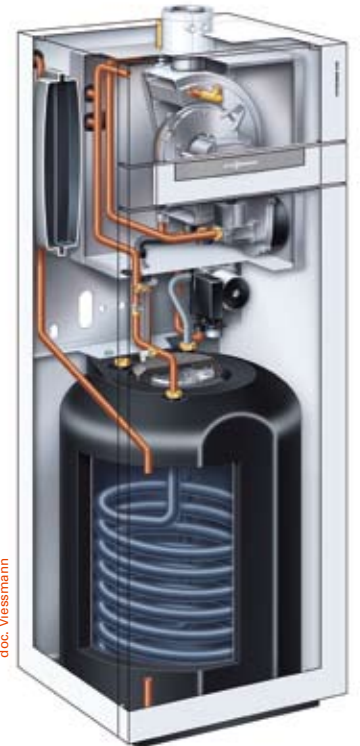
La chaudière compacte Vitodens 333-F, cheminée ou ventouse, propose une plage de puissances de 3,8 à 26 kW. Elle présente une nouvelle version équipée d'un préparateur d'eau chaude sanitaire à serpentin, particulièrement conseillé dans les régions où l'eau est calcaire. Prix public indicatif à partir de 3.538 euros HT et hors pose.
