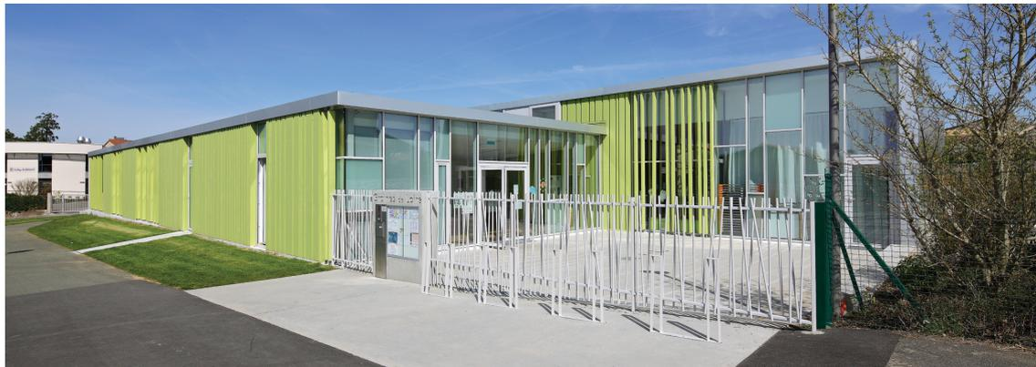
12,5 tonnes de mortier très hautes performances i.design EFFIX ARCA ont été mis en œuvre pour fabriquer les 374 mètres linéaires d'éléments béton constituant les brise-soleil du nouveau Pôle Enfance de Champtoceaux (49).
