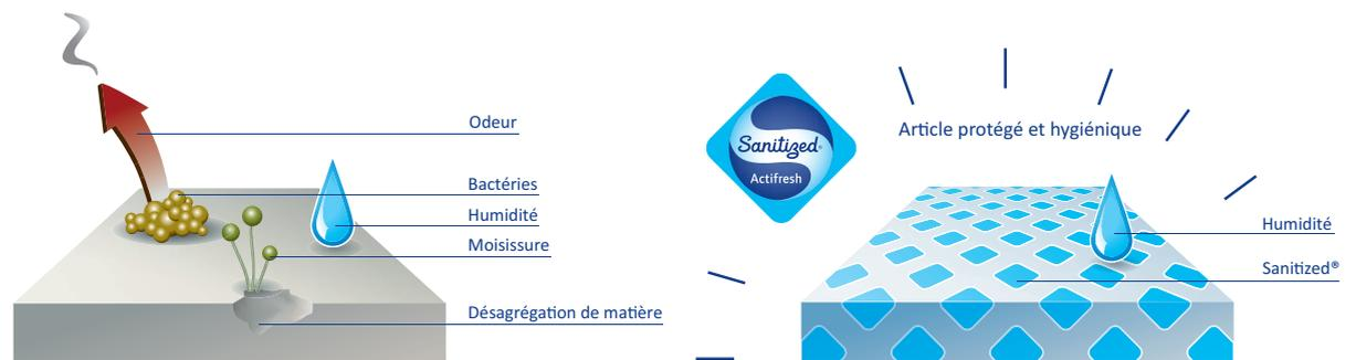
Grâce à la maîtrise du développement de ses propres résines, Polyrey a pu incorporer au sein même de son matériau, la protection antibactérienne **Sanitized®** qui diffusera ses bénéfices tout au long de la durée de vie.
