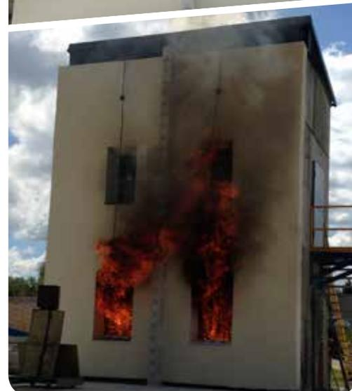
Le test LEPIR 2 réalisé le 25 avril dernier s'avérant concluant, **weber** peut prétendre à une bande sur deux et jusqu'à 30 cm de PSE pour son système **weber.therm XM** : une solution d'ITE sous enduit hydraulique qui va au-delà de la réglementation !
