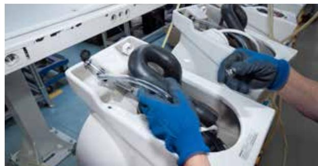
Gros plan sur le montage et le test de chaque Sanicompact
