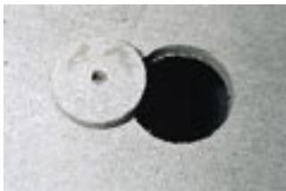
*Pour une adaptation optimale à toute contrainte dimensionnelle, la plaque Aquapanel® de Home Pratik se découpe aisément en fonction de la forme souhaitée, au cutter, à la scie sauteuse ou à la disqueuse, pour des coupes nettes et propres.*
