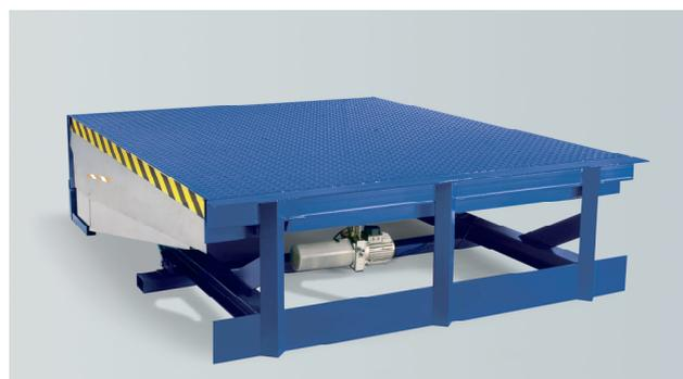
Son fonctionnement par boîtier de commande, actionnant des vérins hydrauliques équipés d'une vanne d'arrêt d'urgence, d'une extrême simplicité d'utilisation, garantit un travail sûr et efficace : après l'accostage du camion, le niveleur est amené à sa position la plus haute et déploie automatiquement la lèvre avant abaissement de la plateforme jusqu'au plancher du véhicule. Inutile de répartir les aires de chargements en fonction du gabarit des poids lourds, tout est pensé !
