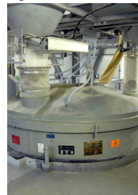
Gros plan sur le malaxeur de 2 m 3
