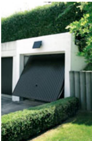
Ici, monté sur le garage, le panneau solaire imaginé par Hörmann alimente en énergie l'accumulateur **ProMatic Akku** du fabricant.
