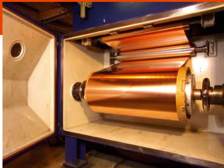
Zoom sur la machine de dépôt du revêtement absorbeur. Le procédé de revêtement PVD (Physical Vapor Deposition) issu de la recherche physique ne produit aucun rejet polluant.
