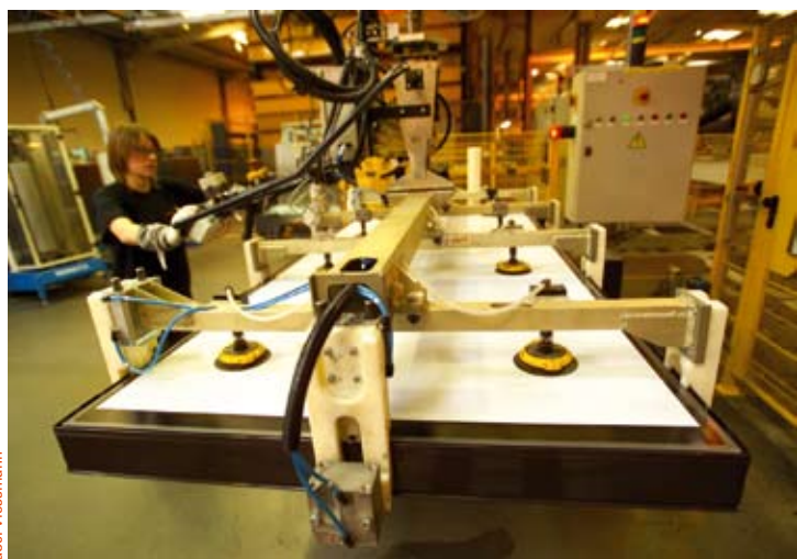
L'assemblage et le conditionnement des capteurs solaires en fin de chaîne de fabrication.
