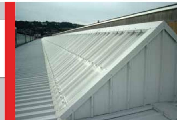
**ISOCLAIR Thermo (PC)** offre un véritable apport thermique ; ce système est composé de trois peaux, une supérieure en polycarbonate, une intermédiaire et une inférieure en polycarbonate alvéolaire (4 mm), uniquement en épaisseurs de 100 et 120 mm. Il partage ses performances (résistance grêle et classement feu) et les mêmes longueurs utiles qu'ISOCLAIR Pro. Notons enfin que son U est d'environ 1,42 W/m<sup>2</sup>.K en épaisseur de 120 mm.
