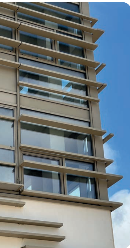
Brise-soleil lames rectangulaires de 50 mm d'épaisseur. Sections de 100, 165 & 230 mm. Pose horizontale sur ossature indépendante. Couleur sable - Terra Cigala®
