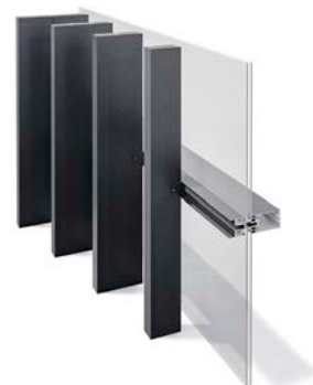
Brise-soleil lames rectangulaires de 50 mm d'épaisseur. Sections de 100, 165, 230, & 300 mm. Pose verticale sur épine.
